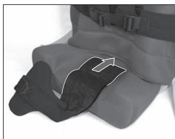
③ 股ベルト本体中心のマジックテープは座面とバックサポートカバーのすき間を通して、バックサポートフレーム裏の取り付け用カンで折り返してマジック面で張り合わせて固定します。この折り返し部分で前後の調節がおこなえます。
