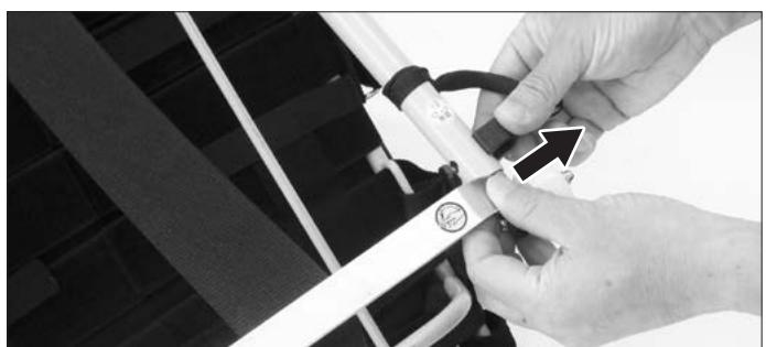
②フレームをスライドさせて長さを変更します。希望するリクライニング角度に応じた穴位置(角度は後述)に合わせます。次のページの中の写真はフレームを最も伸ばしてリクライニングを最大に起こした状態です。リクライニング角度設定の穴は5段階で5個の調節穴があります。
