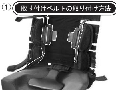
取り付けベルトのホルダー部分を背スリングに貼り付けます。幅はバックサポートカバーのスリット幅に合わせ高さはサポートパッドを付けた状態をふまえて、パッド上縁と脇の下に指1本分の隙間が空くぐらいにしてください。
